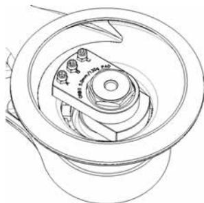
2. Configuration de la machine utilisée avec un protecteur de plateau ou une interface.
